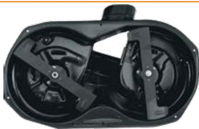
Villager traktorske kosilnice so opremljene z dvojnimi noži v jeklenem ohišju.
